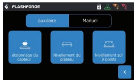
Fonction de nivellement sur 9 points : si après le nivellement de la plateforme et l'étalonnage des axes X, Y et Z la planéité est encore imparfaite, vous pouvez utiliser cette fonction pour l'améliorer.
