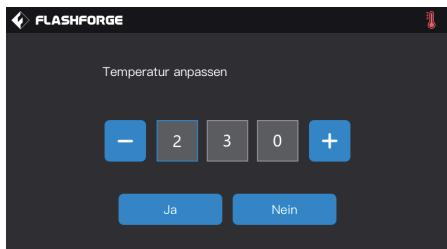
8. Laden: Tippen Sie nacheinander auf die Schaltflächen [Tools]-[Filament] auf dem Bildschirm. Legen Sie die Heiztemperatur gemäß dem benötigten Temperaturwert für das Material fest. Befolgen Sie die Anweisungen auf dem Bildschirm und warten sie, bis das Filament reibungslos aus der Düse austritt.
