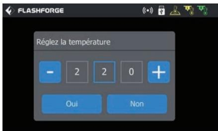
8. Alimentation en filament : cliquez successivement sur les boutons [Outils]-[Filament] de l'écran, puis définissez une température de chauffage raisonnable conformément à la température requise par le matériau. Suivez les invites qui s'affichent, et attendez que la buse extrude sans heurts un filament uniforme.
