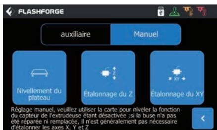
Mode de nivellement manuel : Exécutez successivement le nivellement de la plateforme, l'étalonnage de l'axe Z et celui des axes X et Y. C'est un ensemble complet de procédures de nivellement et d'étalonnage.
