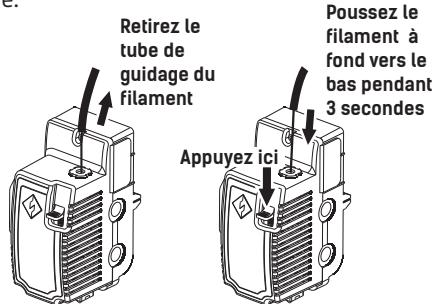
Déchargement du filament : cliquez sur [Décharger], appuyez sur la plaque de pression du filament une fois que l'extrudeuse a atteint la température de consigne, tirez sur le tube de guidage blanc du filament pour le retirer, puis tirez rapidement le filament vers le haut. Le déchargement est alors terminé.
