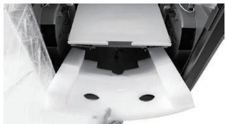
6. Halten Sie [Z-] angetippt, bis sich die Konstruktionsplattform anhebt. Nehmen Sie dann den Schaumstoffblock darunter heraus.
