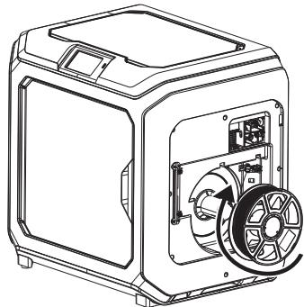
3. Achtung: Setzen Sie das Filament bitte in der auf der Abbildung gezeigten Richtung ein. Das vereinfacht die reibungslose Drehung des Filaments.
