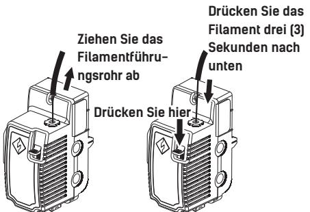
Entladen: Tippen Sie auf [Entladen], drücken Sie die Filament-Andrückplatte herunter, sobald die richtige Extrudertemperatur erreicht ist. Ziehen Sie das weiße Filamentführungsrohr herunter und ziehen Sie das Filament schnell nach oben. Dann ist das Entladen des Filaments abgeschlossen.
