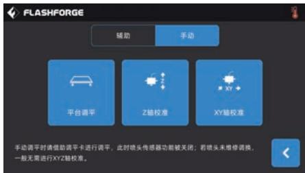
手动调平模式：依次执行平台调平、Z轴校准、XY轴校准。此为一套完整的调平校准操作流程。
