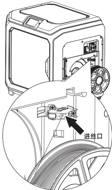
2. 取出耗材，将耗材插入进丝口中。
