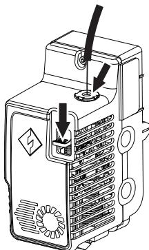
4. Continuez l'insertion du filament dans l'entrée d'alimentation en filament jusqu'à ce qu'il ait traversé le tube de guidage.
