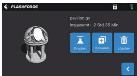
4. Berühren Sie [Drucken] (Konstruktion).
