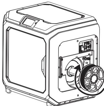
3. 注意：为方便耗材转动顺畅，请按图中所示的方向安装耗材。
