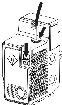
4. Setzen Sie das Filament ohne Unterbrechung in die Filamentzuführung ein, bis das Filament durch das Filamentführungsrohr geführt wird.
