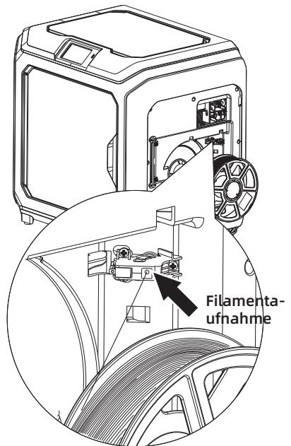
2. Nehmen Sie das Filament heraus und führen Sie es durch die Filamentzuführung.
