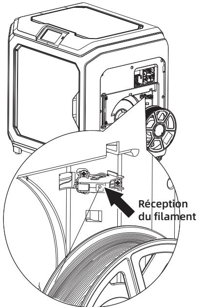
2. Tirez sur le filament et insérez-le dans l'entrée d'alimentation en filament.
