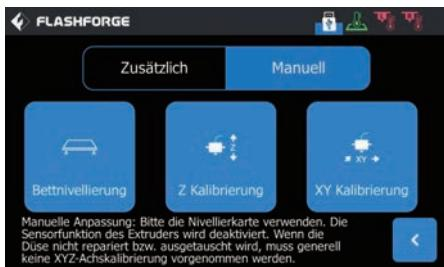
**Manuelle Nivellierung:** Führen Sie nacheinander die Plattform-Nivellierung, Z-Achsakalibrierung und die X-/Y-Achskalibrierung durch. Es handelt sich um einen kompletten Satz der Nivellierung- und Kalibriervorgänge.
