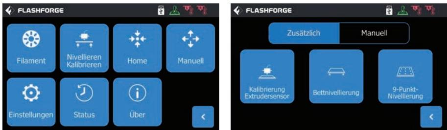
**9-Punkt-Nivellierung:** Wenn die Flachheit des Druckers nach der Plattformnivellierung und XY/Z-Achskalibrierung weiterhin nicht zufriedenstellend ist, kann diese Funktion verwendet werden, um die Flachheit zu verbessern.
