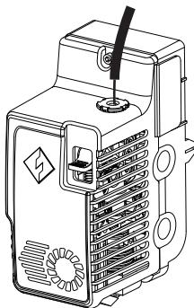
4. 持续将耗材送入进丝口，直到耗材从导丝管穿出。
