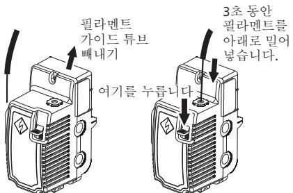
필라멘트 언로딩 작업: [언로드]를 클릭하고 Extruder 온도 가열이 완료된 후 필라멘트 누름판을 아래로 누르고 흰색 필라멘트 가이드 튜브를 당겨 빼낸 후 Filament를 재빨리 위로 잡아당기면 필라멘트 언로딩이 완료됩니다.
