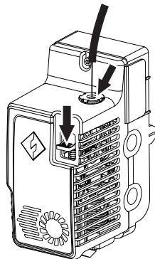
5. 按下喷头前方的进丝压板，将耗材垂直插入喷头，直到无法继续插入。松开进丝压板。
