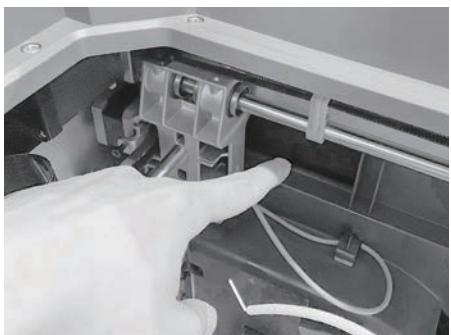
4. Retirez les attaches des courroies synchrones des axes X et Y.
