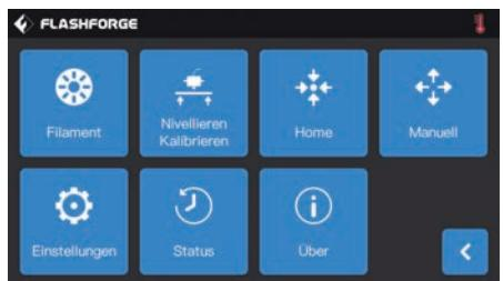
5. Verbinden Sie den Drucker mit der Stromversorgung. Tippen Sie nach dem Einschalten nacheinander auf dem Touchscreen auf [Tools] und [Manuell], um auf die manuelle Steuerschnittstelle zuzugreifen.
