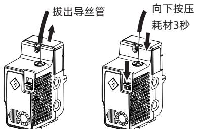
退丝操作：点击【退丝】，待喷头温度加温完成后，向下压耗材压板，拔出白色耗材导丝管，将耗材迅速向上拔出，退丝完成。
