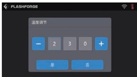
8. 进丝操作：点击屏幕中的【工具】-【换丝】按钮，根据材料所需温度值设置合理加热温度；根据屏幕提示进行操作，等待喷嘴挤出均匀的耗材。
