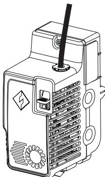
6. 将导丝管插入喷头进丝孔中固定。
