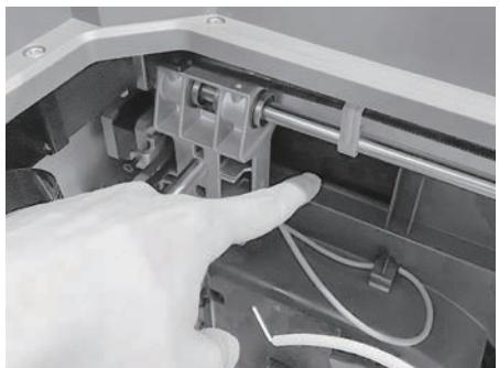
4. Entfernen Sie die Schnallen an den Synchrongurten der X-Achse und der Y-Achse.
